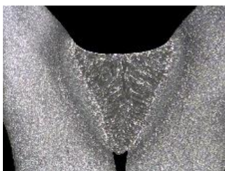
Obr. 5: Charakteristika PCS se vyznačuje zaostřeným obloukem, který zajišťuje hluboký profil průvaru. Je vhodná zejména pro použití v úzkých spárách a pro svařování koutových svarů a kořenových vrstev.
