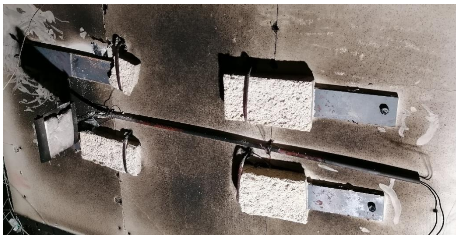
Obr. 5: Vzorky po požárním experimentu, u jednoho došlo k odpadnutí ochranné vrstvy
